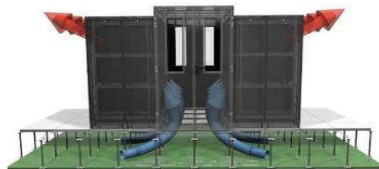
Подача воздуха в помещение, вытяжка через фальшпотолок
