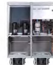
Установка вентиляторов под фальшполом уменьшает их потребляемую мощность на 20 % при таком же расходе воздуха
